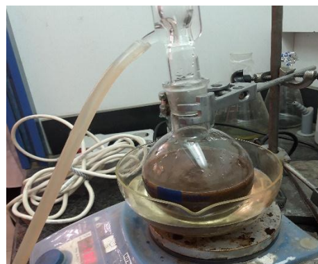
تهیه عصاره آبی با استفاده از روش جوشاندن
