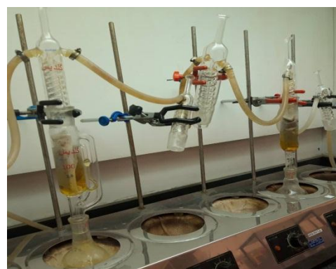
تهیه عصاره الکلی با استفاده از دستگاه سوکسوله
