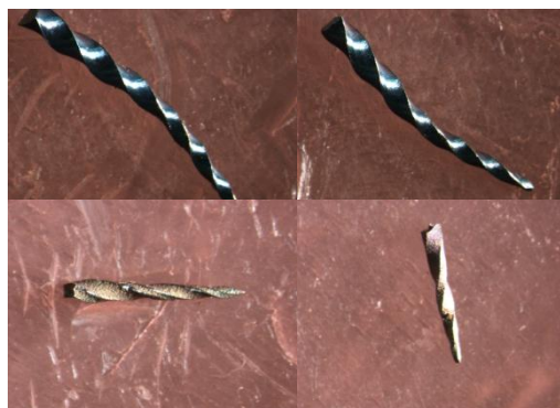
شکل ۱- قطعات شکسته فایل ها زیر میکروسکوپ دیجیتالی
