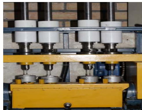
شکل ۲- دستگاه cyclic loading (custom made) جهت وارد کردن نیروهای فشاری تکرار شونده
