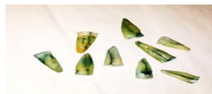
شکل ۱- چگونگی رنگ پذیری شکستگی ها توسط متیلن بلو
