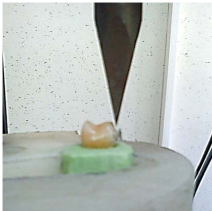
شکل ۱: محل اعمال نیرو با دستگاه Universal Testing Machine
