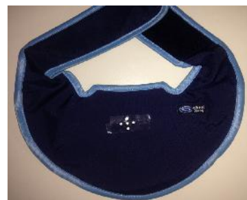
شکل ۱- محل قرار گیری دوزیمترها روی محافظ
