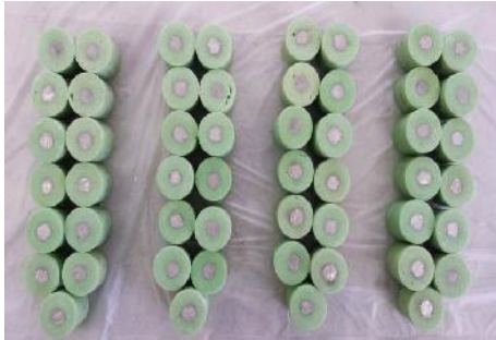
شکل ۱- آمالگام‌های درون سیلندر
